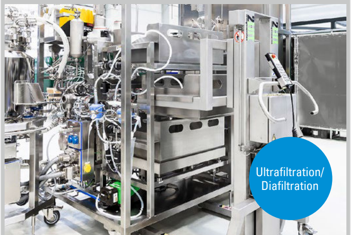
Ultra-/Diafiltrationsskid mit integriertem Bag-Holder-Skid und Waage sowie kundenspezifischen Boxen und Hebelift für einen sicheren Transport der Produkte-Bags.
