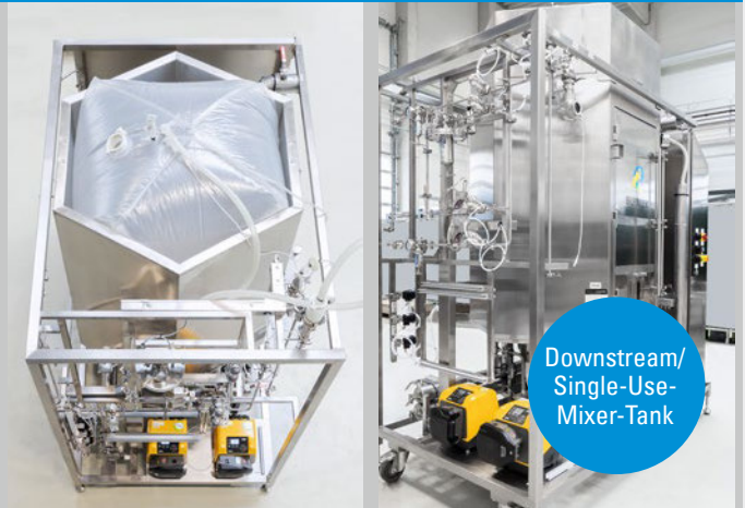
Single-Use-Bag in einem Single-Use-Mixer-Tank-Skid. Durch das solide ausgeführte Tubing-Management des Edelstahl-Skids wird der Betrieb der Single-Use-Komponenten bedienerfreundlicher und verlässlicher.
